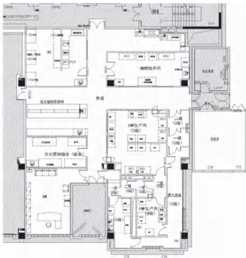
图 1 干细胞移植实验室建筑平面布置
