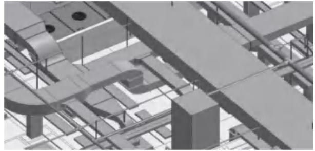
图4 干细胞移植实验室净化空调系统的3D设计
